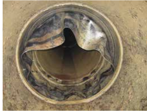
Wenig Wasser auf der Strassenoberfläche – grosse Wirkung in der Filtratleitung
