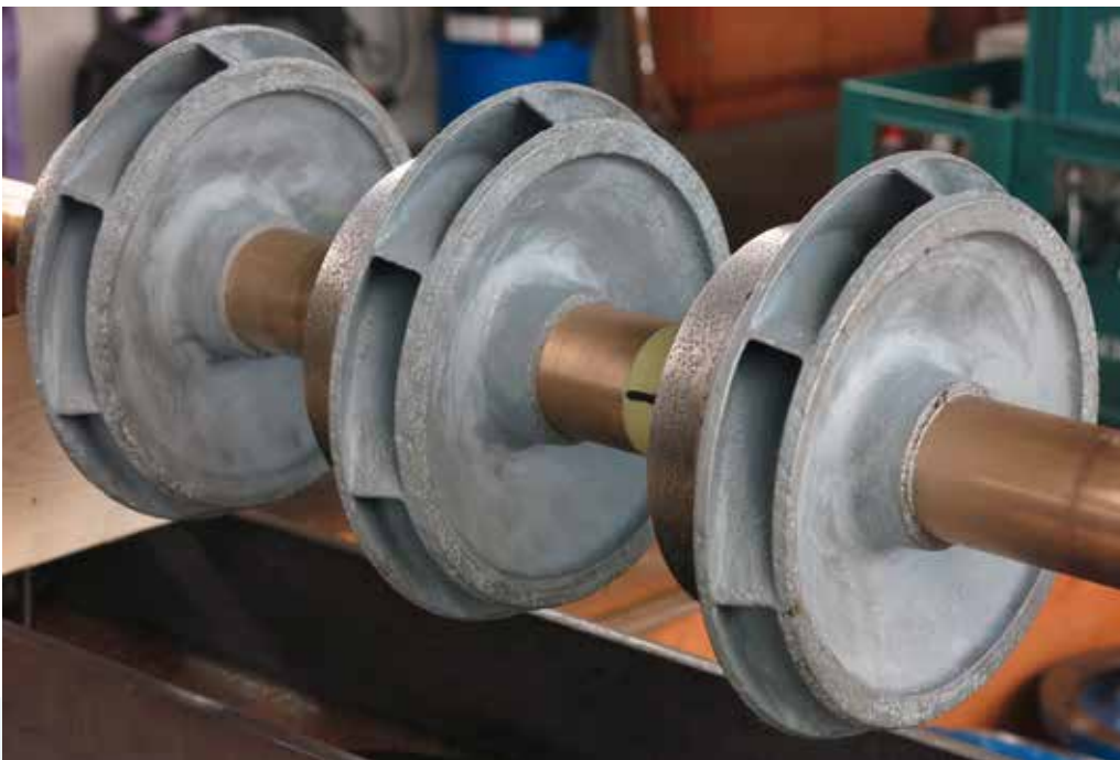
Rundernerneuete Pumpenlaufräder werden zum Auswuchten auf die Antriebswelle montiert.
