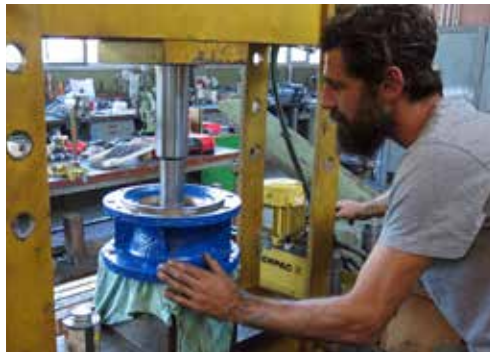
In das fertig revidierte Bohrlochpumpengehäuse wird noch eine Lagerbüchse eingepresst.
