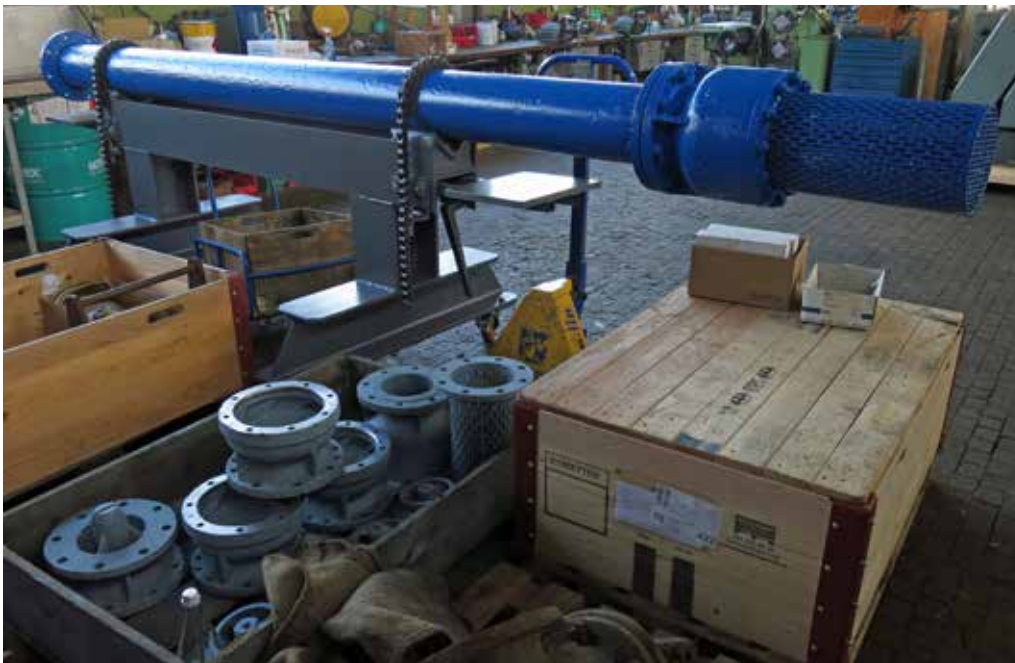
Das unterste Rohrstück einer Bohrlochpumpe mit Ansaugrohr und Lochsieb-Einlauf (Seiher) auf dem Eigenbau-Montagebock
