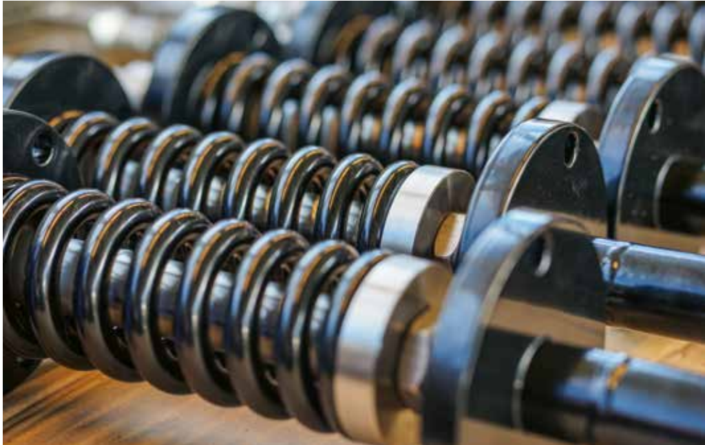
Diese Druckfedern sorgen für das dosierte Anpressen der Verschluss-Walzen.
