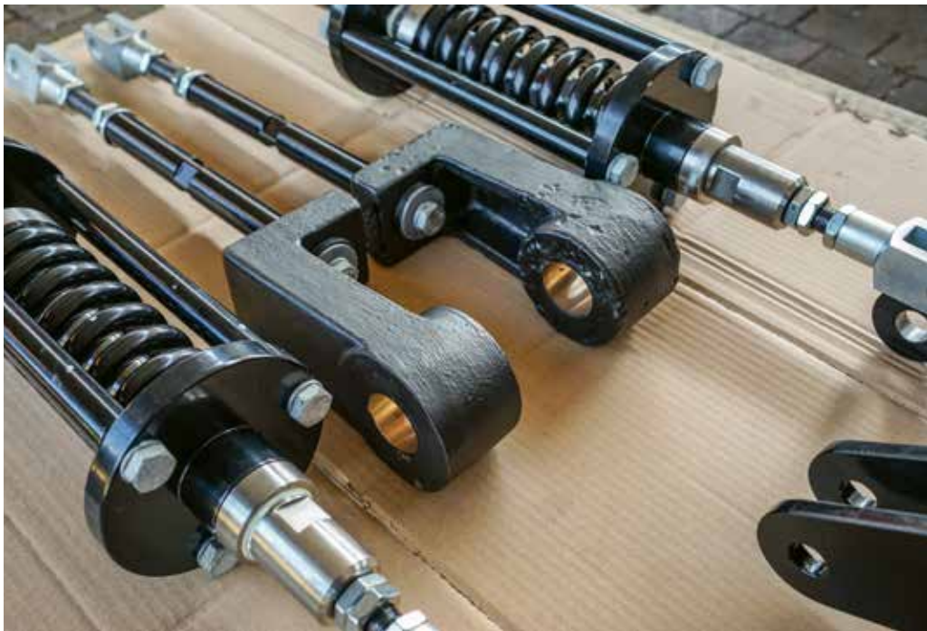
In der Hardwasserwerkstatt gefertigte Bauteile für das Schlammwasserventil von Filter F02.
