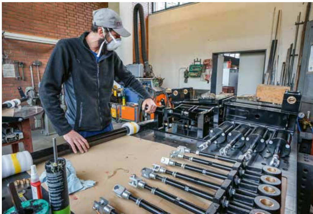
Samuel Müller montiert einzelne Bauteile für das Schlammwasserventil von Filter F02 zu einer Baugruppe.
